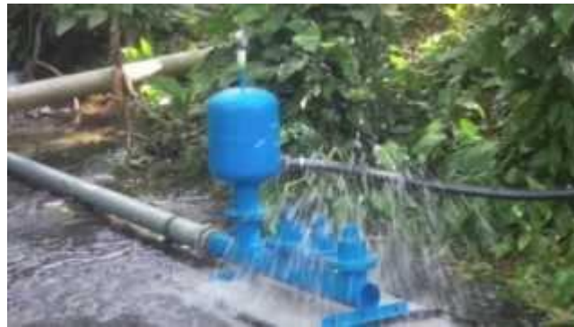
Figura 22. Bomba de ariete multipulsor. [Autor]
