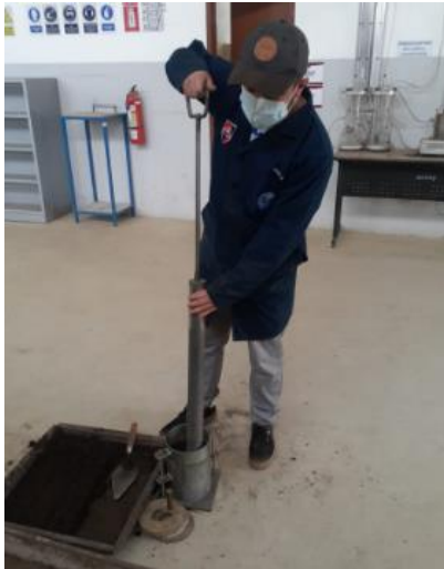
11, 27 y 56 golpes para ensayo de CBR
