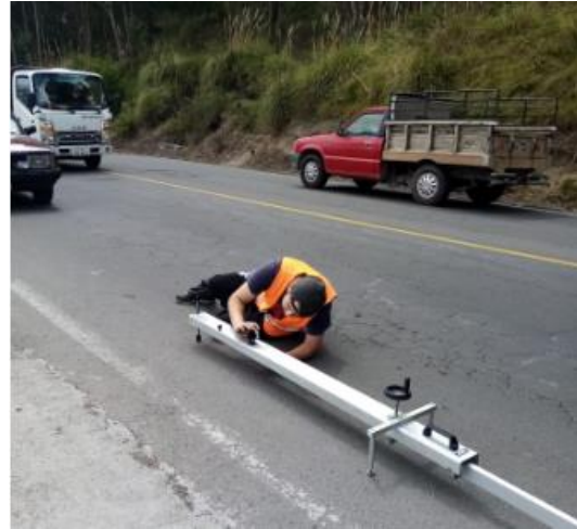
Toma de lectura en la Viga Benkelman
