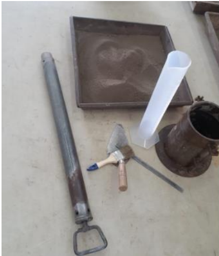
Materiales y equipo para el ensayo de proctor
