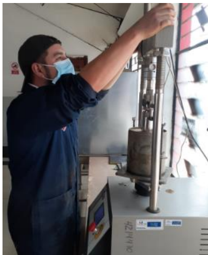
Preparación de la máquina para ensayo CBR
