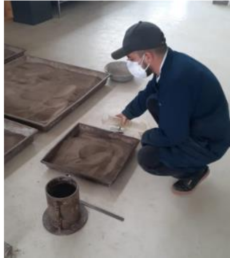
Colocación de agua según w% óptimo
