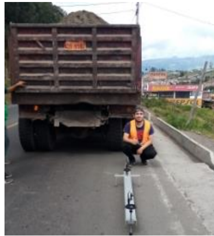
Ensayo Viga Benkelman
