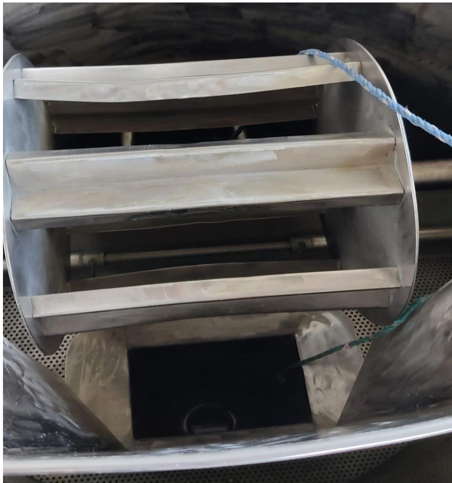
Tambor mezclador, interior máquina de tinturado.
