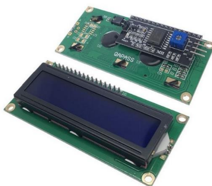
Figura 10.- Pantalla LCD con módulo I2C [39].
