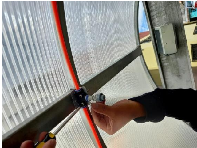
Figura 17.- Ajuste de nebulizadores a la cabina. Elaborado por: El investigador.
