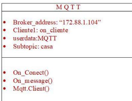
**Figura 41:** Diagrama de Conexión MQTT
