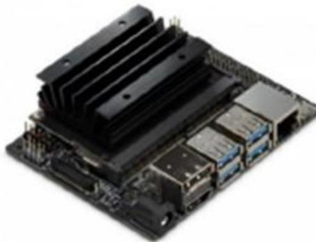
Figura 10: Placa física Nvidia Jetson Nano [25].
