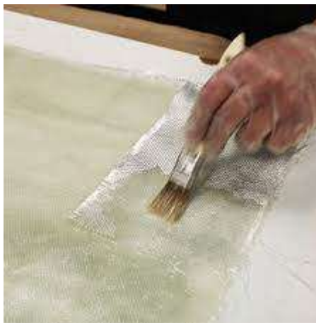
Figura 7: Fibra de vidrio más resina poliéster.
