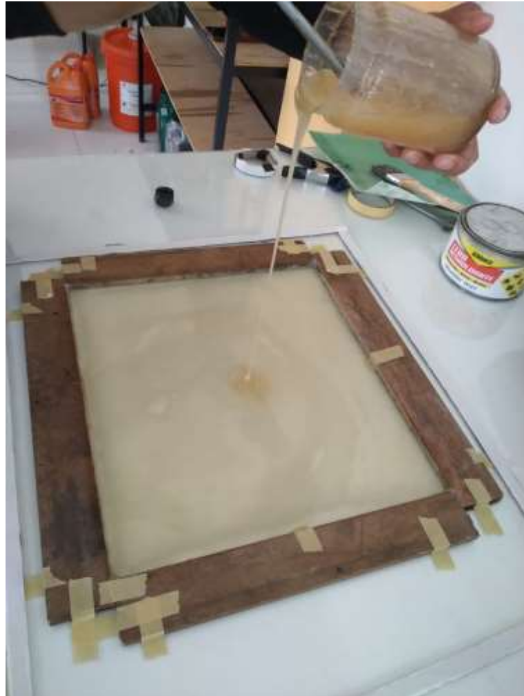
Figura 54: Fabricación de placa de resina aeropoxy
