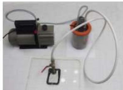
Figura 10: sistema de vacío para materiales compuestos en Chile. [13]
