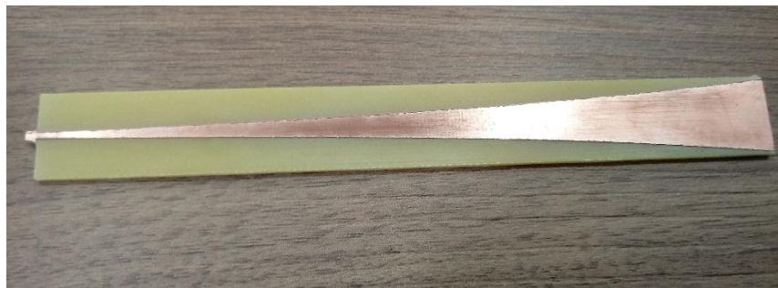
Figura 36: Acoplador de 50 Ohms en baquelita de cobre.
