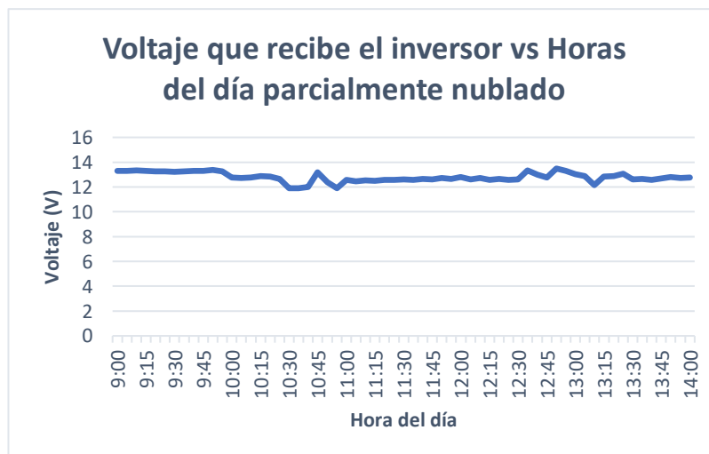
Figura 63: Voltaje que entrega el regulador solar al inversor de voltaje
