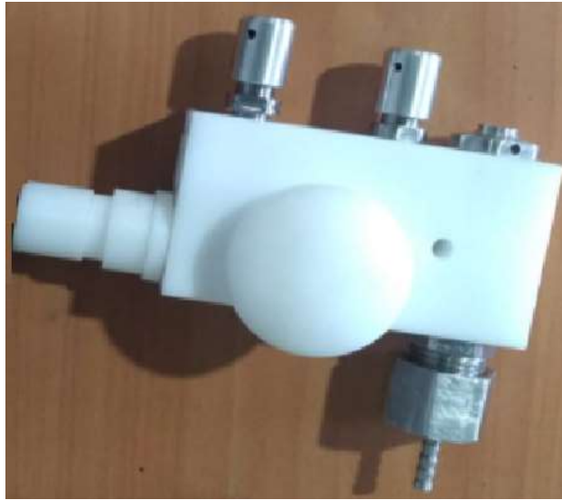
Fig. 98 Prototipo de poliacetal ensamblado
