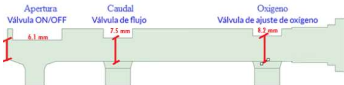
Fig. 78 Apertura máxima válvulas
