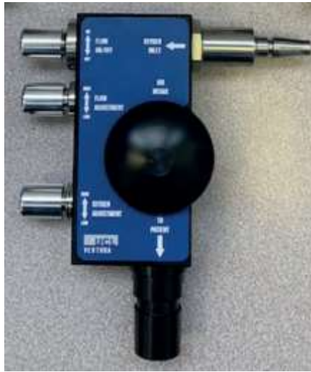
Fig. 3 UCL Ventura CPAP [6]
