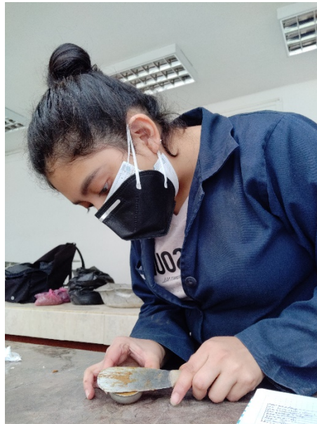
Figura 28 Enraizado del suelo con la espátula
