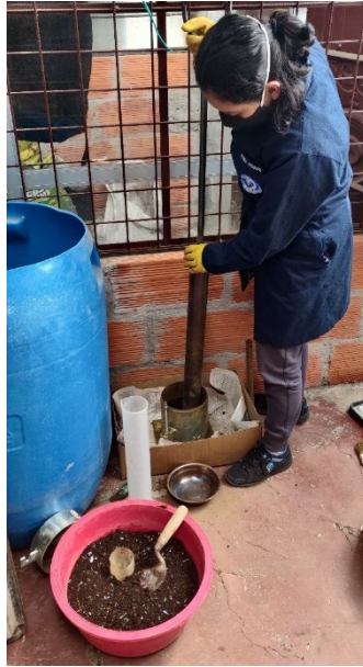
Figura 29 Compactación del suelo
