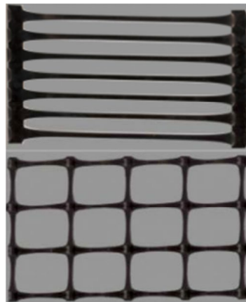
Figura 9 Estructura de la geomalla
