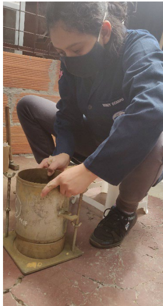
Figura 57 Armado del molde de 6”
