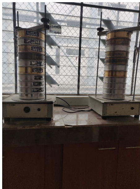
Figura 51 Tamizado de muestras
