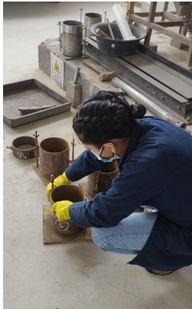
Figura 61 Limpieza de moldes
