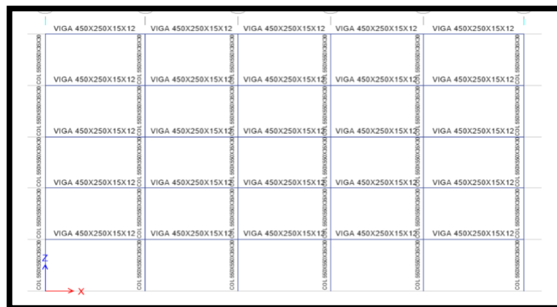
Figura 65: Modelación del pórtico seleccionado en sentido X – Eje 2
