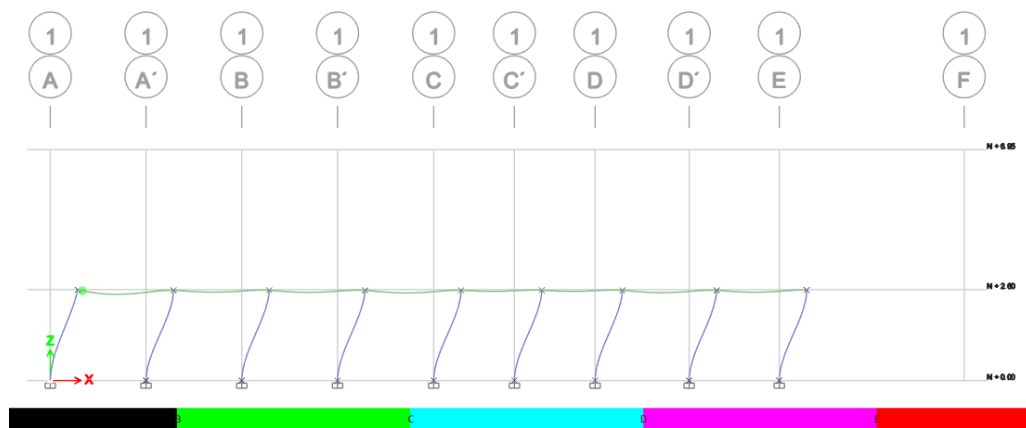
Figura 249: Formación de Rótula plástica eje 1 sentido X
