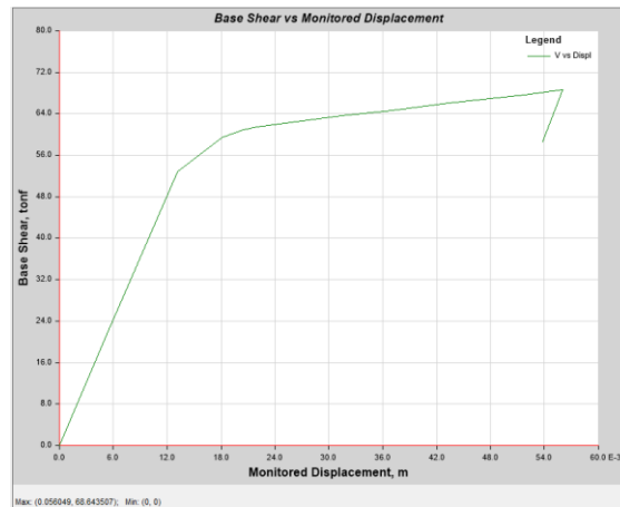
Figura 257: Curva capacidad en X
