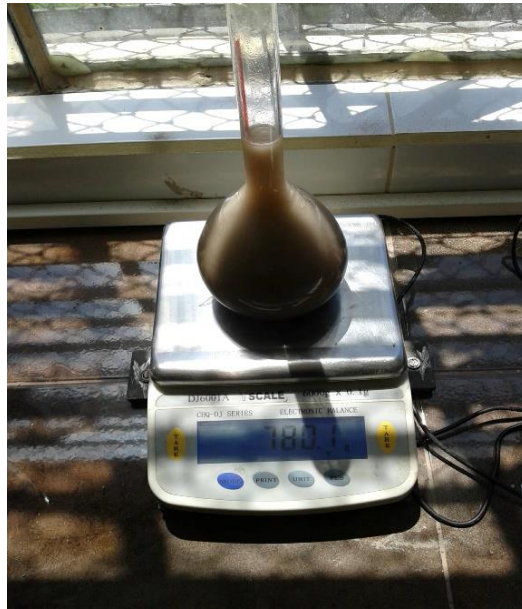
Figura 42 Pesado de la muestra con agua para la determinación de la densidad relativa Fuente: El autor
