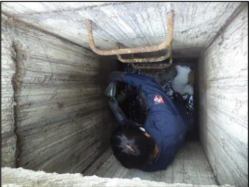
Figura 14 Toma de muestras de agua tratada de salida de la planta de Puñachizag Fuente: El autor
