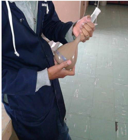
Figura 41 Eliminación del aire contenido en la muestra para determinar la densidad relativa Fuente: El autor
