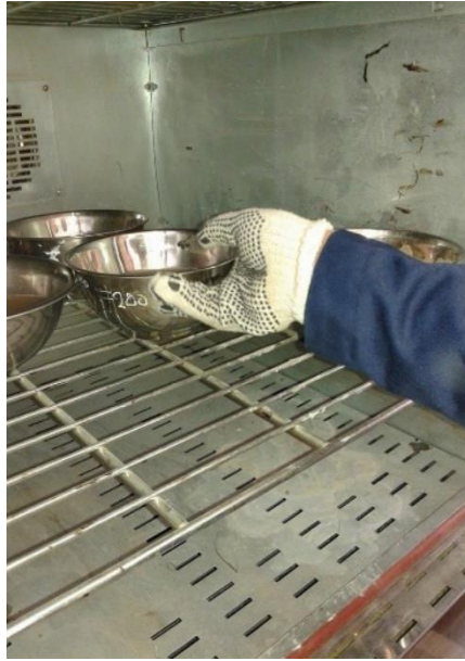
Figura 40 Colocación de la muestra de arena en el horno para determinar la densidad relativa de la misma Fuente: El autor
