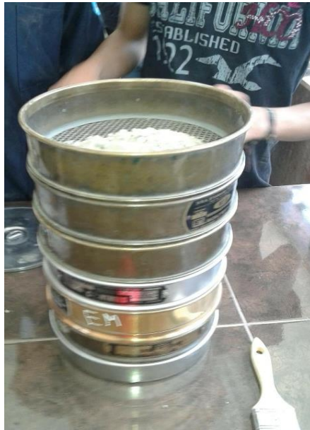
Figura 43 Preparación de la muestra en los tamices para la determinación de su granulometría Fuente: El autor
