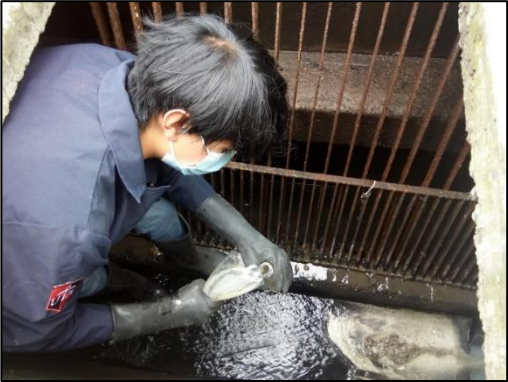
Figura 13 Toma de muestras de agua residual de ingreso a la planta de Puñachizag Fuente: El autor
