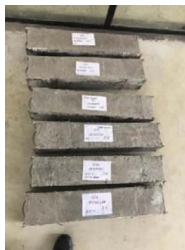
Ilustración 31. Vigas realizadas en base a NTE INEN 1576
