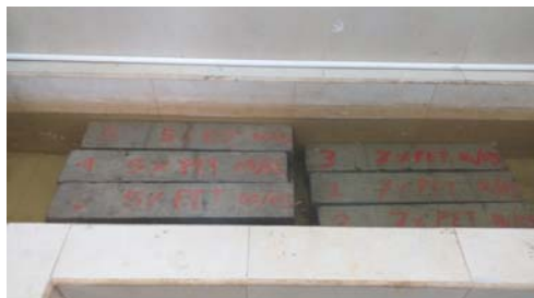
Ilustración 33. Vigas sumergidas en la cámara de curado hasta su ensayo
