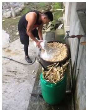
Ilustración 12. Adición del hidróxido de calcio
