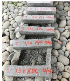
Ilustración 32. Curado inicial de vigas
