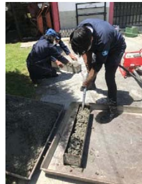
Ilustración 30. Vibrado de vigas para flexión
