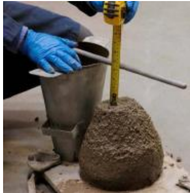
Figura 10. Slump o asentamiento del concreto
