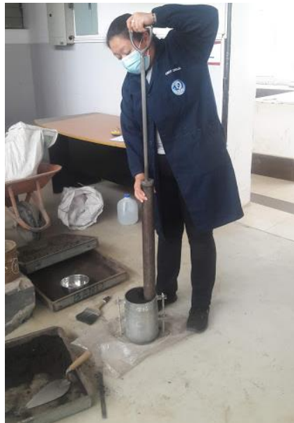
Figura 25. Compactación del suelo
