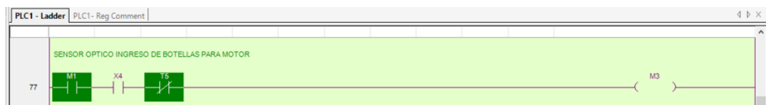
Figura 96. Sensor óptico ingreso de botellas para motor
