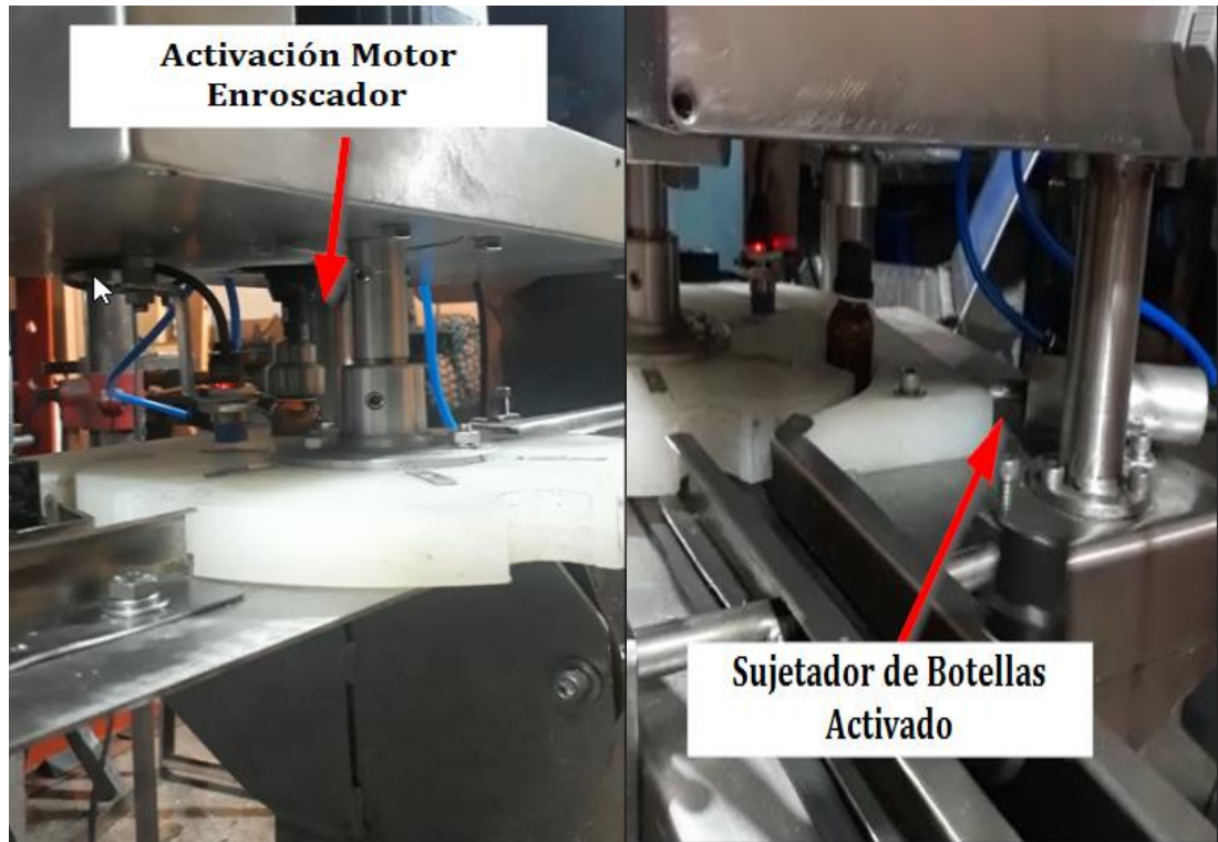
Figura 102. Activación de Motor enroscador y cilindro sujetador de botellas
