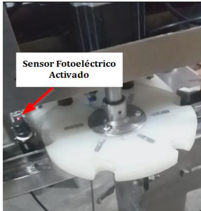
Figura 97. Activación del Sensor Fotoeléctrico en el ingreso de botellas
