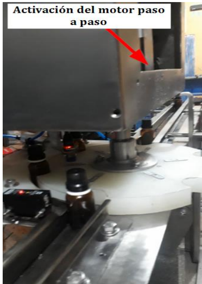
Figura 105. Activación física del motor paso a paso en el proceso de sellado
