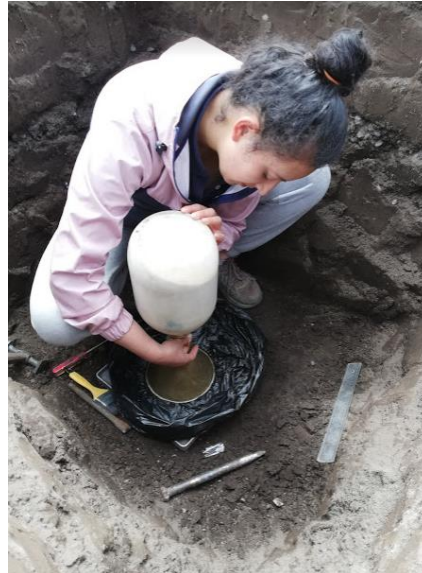
Figura 3. Ensayo de Cono y Arena
