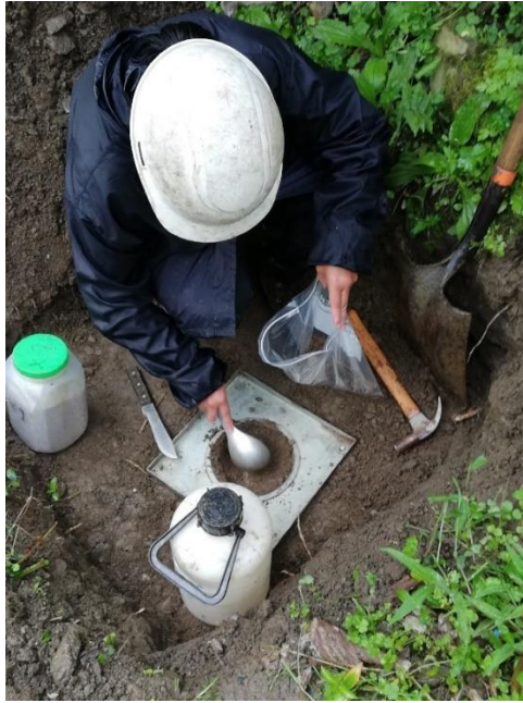
Figura 64. Toma de muestra de suelo para posterior análisis.
