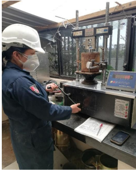
Figura 26. Ensayo C.B.R, M2-Río Blanco.
