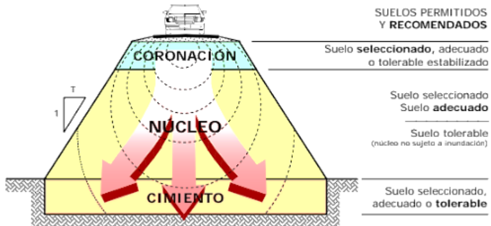
Figura 9. Zonas de un Terraplén.
