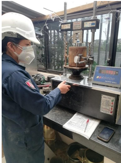
Figura 83. Ejecución del ensayo CBR - Puntual.
