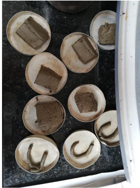
Figura 74. Muestras de suelo previo a colocarlas en el horno.
