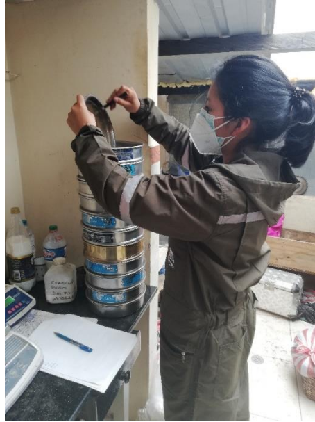
Figura 22. Análisis Granulométrico. Colocar la muestra de suelo dentro del juego de matices.
