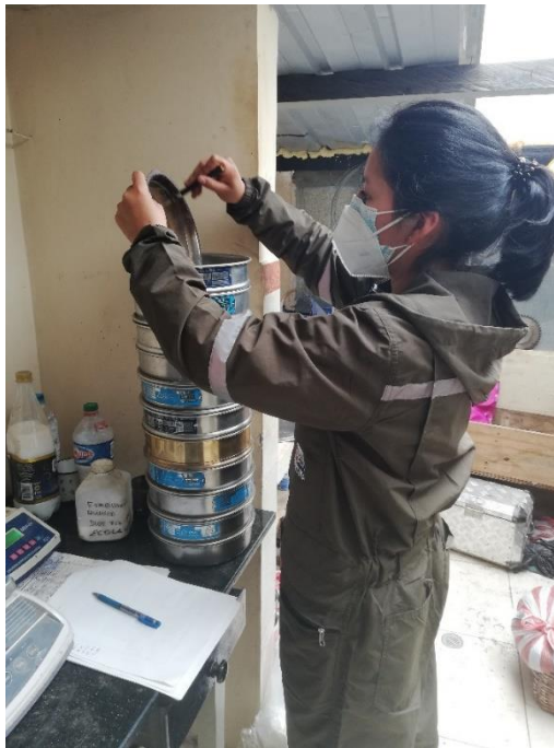
Figura 71. Puesta de muestra dentro de la serie de tamices. Autor: Silvia Paulina Sánchez Ch.
