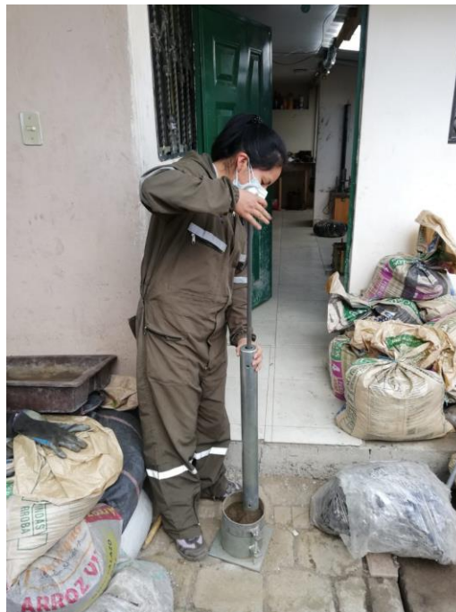
Figura 25. Ensayo compactación, Próctor Modificado “B”, M3-Río Blanco.
