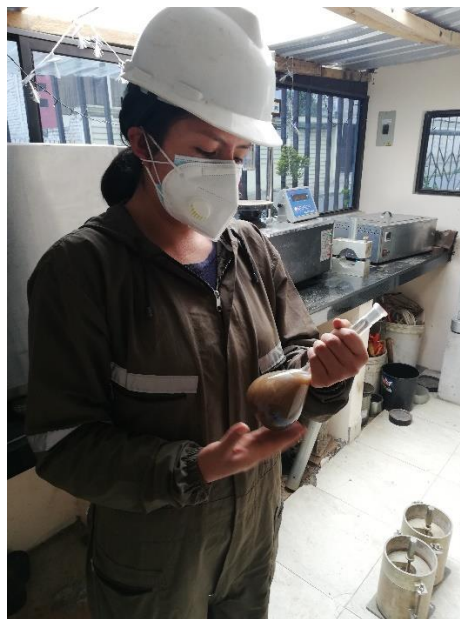
Figura 21. Ensayo de Gravedad Específica.
