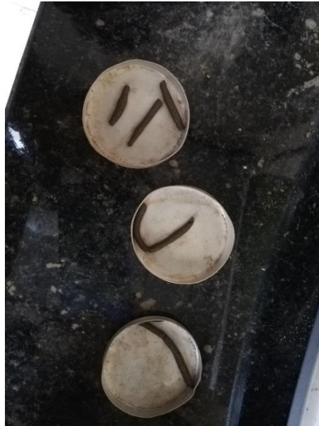
Figura 24. Ensayo Límite Plástico, M1-Río Blanco.
