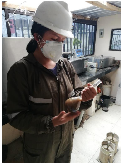
Figura 75. Extracción de burbujas del aire de la muestra.
