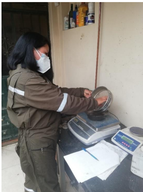
Figura 72. Pesaje de muestra retenida en cada uno de los tamices.
