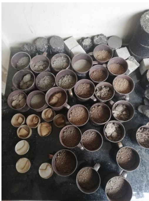
Figura 79. Muestras de suelo posterior a desecación en el horno.
