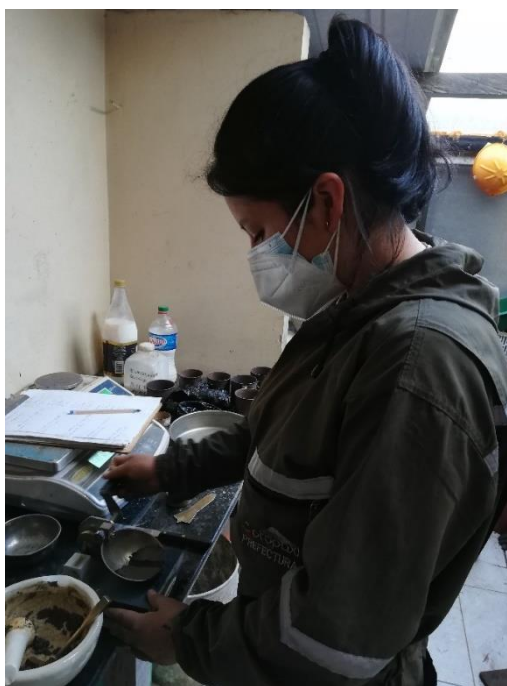
Figura 73. Ejecución del ensayo Límite Líquido.
