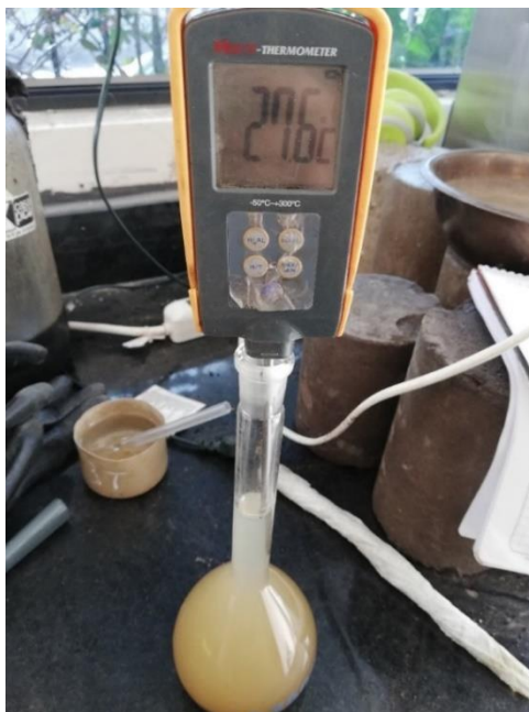
Figura 76. Toma de la temperatura del suelo en el picnómetro.
