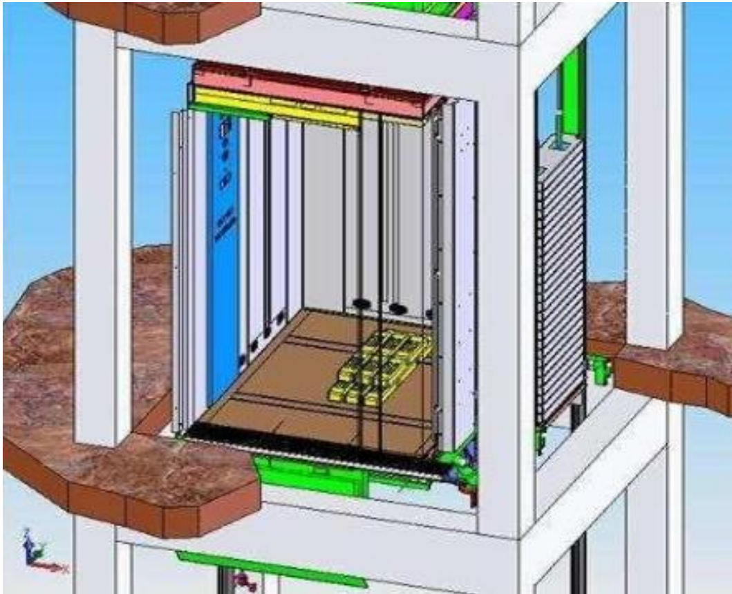
Figura 53. Balanceo de cabina en la mitad del ducto. Tomado de: TECMEIN, (2020).
