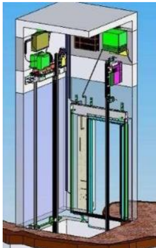
Figura 31. Instalación del conjunto autotransformador y caja de enchufes en el sobre-recorrido. Tomado de: TECMEIN, (2020).
