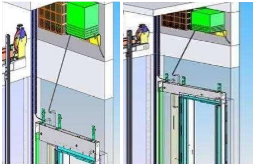
Figura 30. Instalación del conjunto autotransformador en el sobre-recorrido. Tomado de: TECMEIN, (2020).
