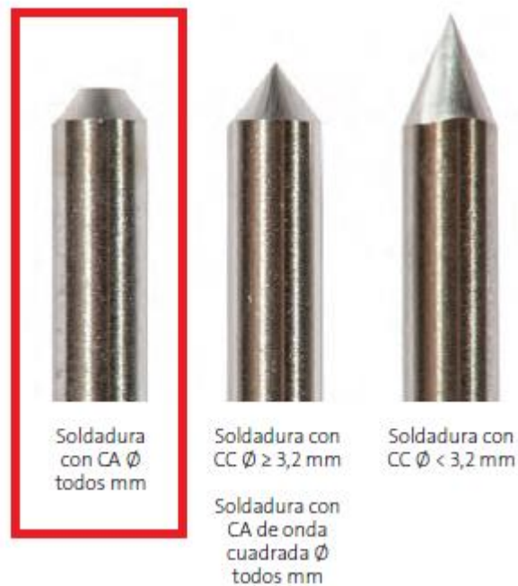
Figura 2-37. Afilado del electrodo en soldadura TIG [49]
