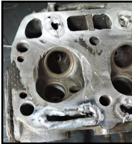
Figura 2-44. Cabezote de aluminio con defectos
