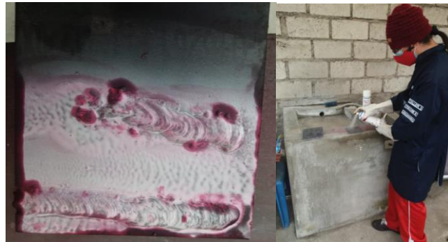
Figura 2-23. Aplicación de revelador
