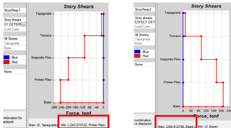
Figura 97: Cortante basal estático vs cortante basal dinámico Sentido Y DETERM
