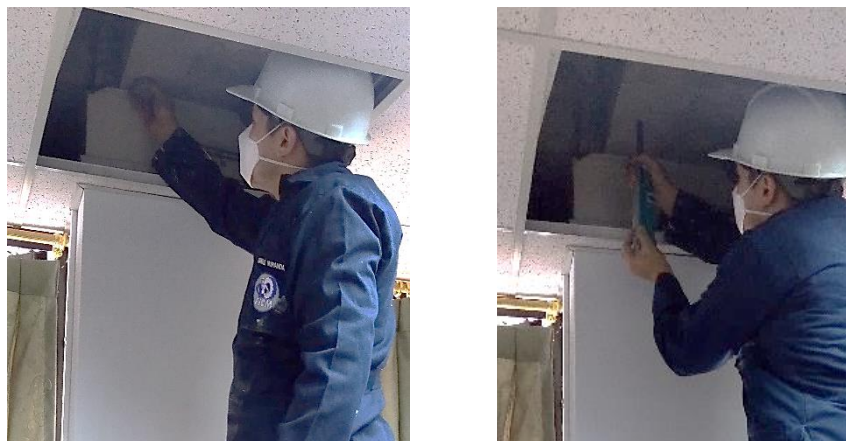
Figura 61: Preparación de la superficie y aplicación del esclerómetro respectivamente.
