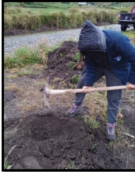
Figura 25: Excavación del Pozo a cielo abierto
