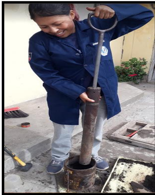
Figura 32: Proceso de dar 56 golpes por capa.
