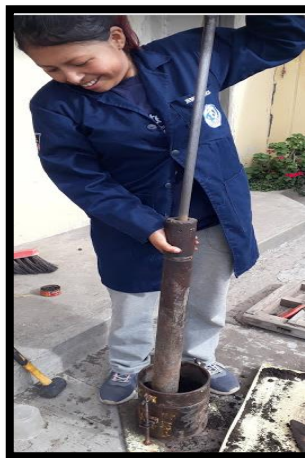
Figura 86: Golpeando la muestra con 56 golpes
