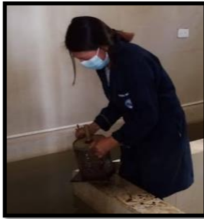
Figura 93: Colocando el cilindro en la cámara de curado
