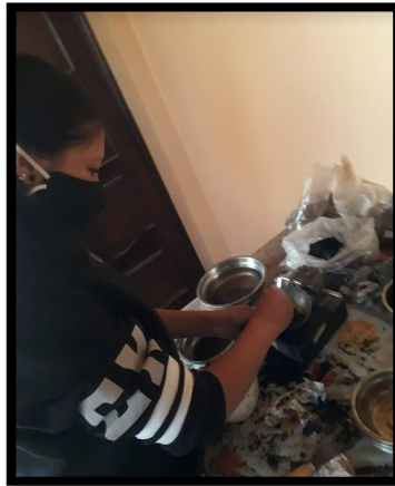
Figura 82: Colocando la muestra en la copa de Casa Grande
