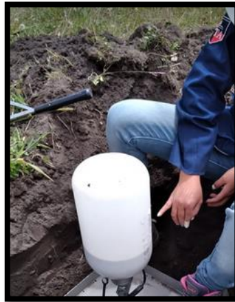
Figura 76: Observando como desciende la arena de Ottawa
