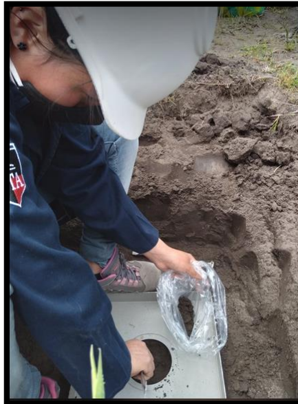
Figura 26: Recolección de la muestra de suelo
