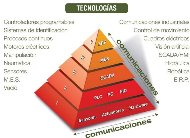
Figura 11. Pirámide de Automatización [23]
