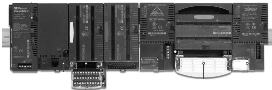
Figura 7.- PLC modular marca General Electric [13]
