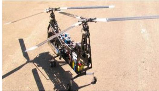
**Figura 3:** Helicóptero en configuración Tadém [16]
