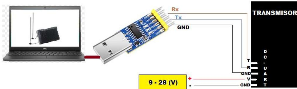
**Figura 48** diagrama de conexión de unidad aérea y PC al convertidor USB/TTL
