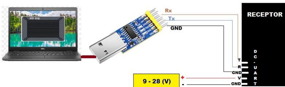
**Figura 34** Diagrama de conexión para configuración de datos
