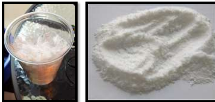
Figura 32. Fibra de vidrio alargada – recortada longitud menor a 2 mm / Fibra de vidrio en polvo
