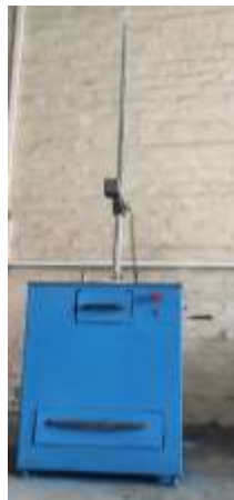
Figura 63 Ensayo de impacto para probetas de PET con fibra de vidrio en polvo.
