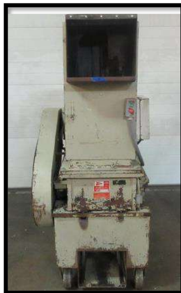
Figura 17. Trituradora de botellas plásticas Nelmor - Modelo (G1215 M1) [19]
