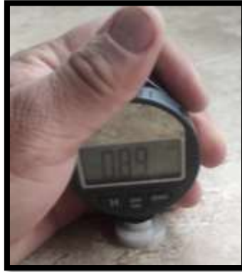
Figura 62 Aplicación del ensayo de dureza Shore D
