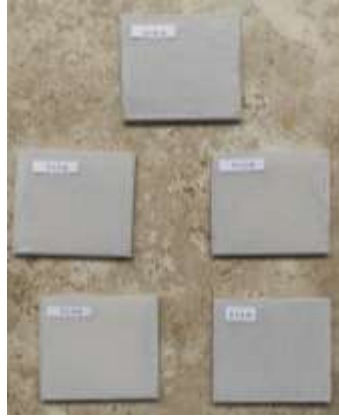
Figura 64. Probetas para el ensayo de impacto del material compuesto de 90% PET + 10% fibra de vidrio en polvo
