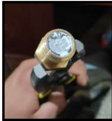
Figura 34. Obstrucción de boquilla con PET sin el proceso de pelletizado
