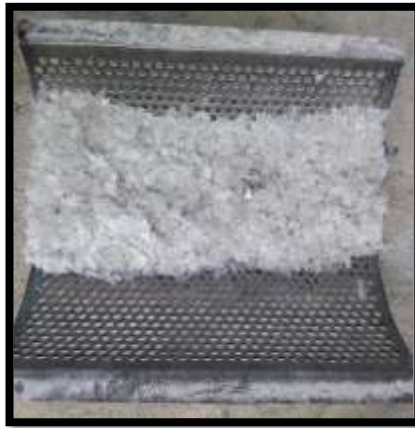
Figura 18. Criba para tamizar plástico triturado a un tamaño de 1,5 mm [19]
