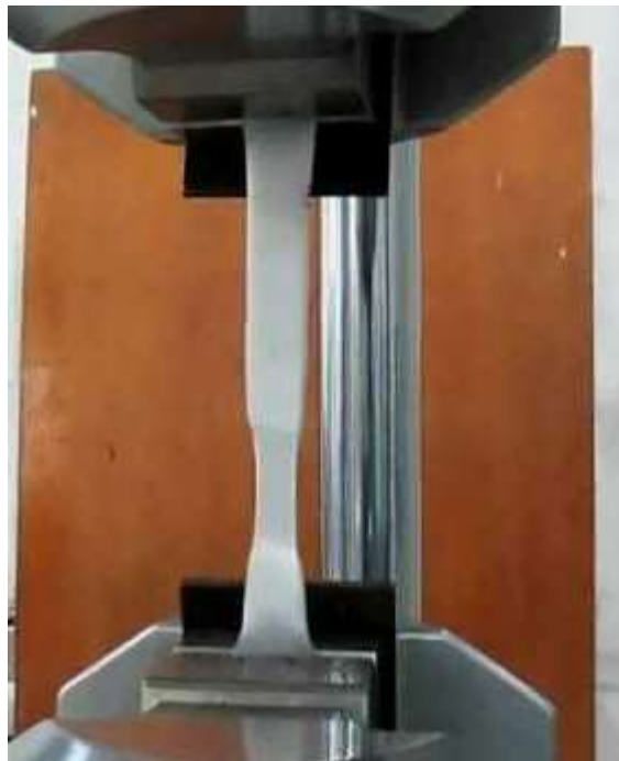
Figura 66 Ensayo de resistencia a la tracción de probetas de 90% PET con 10% fibra de vidrio en polvo.
