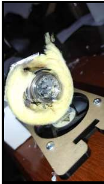
Figura 36. Obstrucción entre barril y tornillo con el PET sin el proceso de pelletizado
