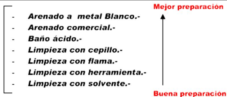
Métodos de preparación superficial para los procesos de aspersión térmica [13]
