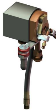
Figura 1.13.- Equipos empleados para el proceso de aspersión térmica por Plasma [23]
