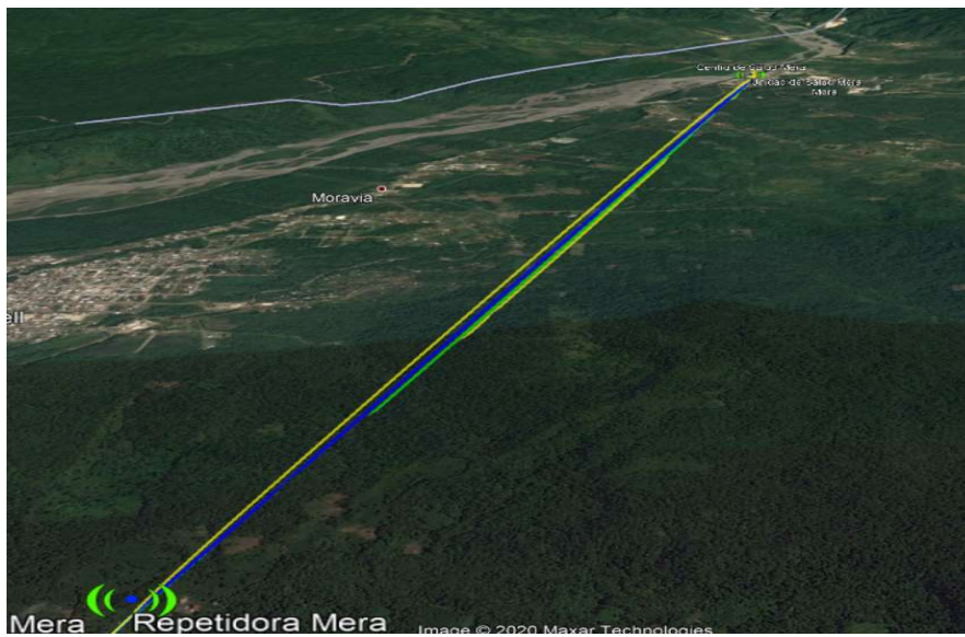
Figura 3. 45. Enlace entre la Repetidora y la Unidad de Salud Mera obtenido por Google Earth
