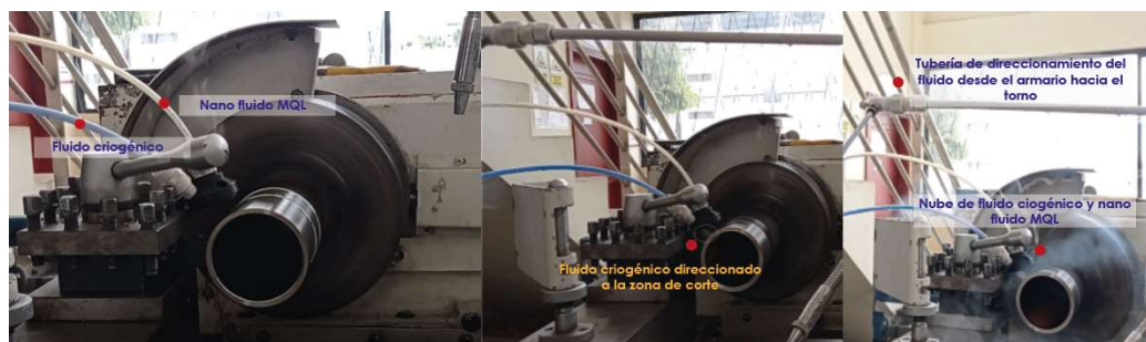
Fig. 26 Funcionamiento del sistema de distribución del fluido criogénico junto con el nano fluido MQL
