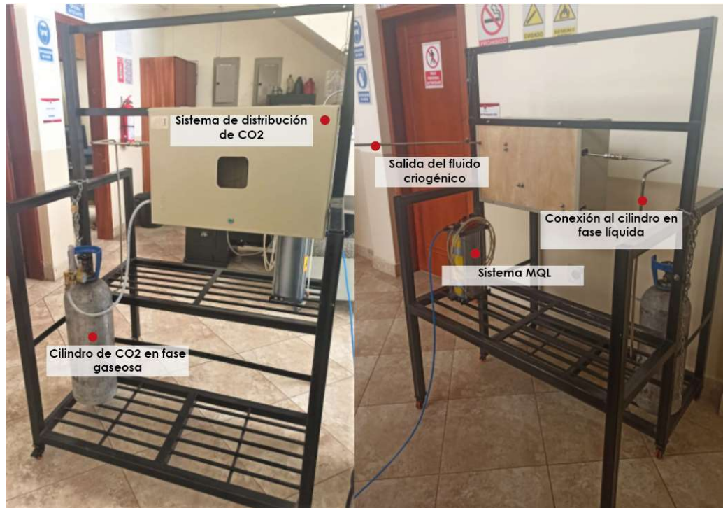
Fig. 25 Armario "plug and play" de lubricación pulverizada MQL con nano fluido y fluido criogénico
