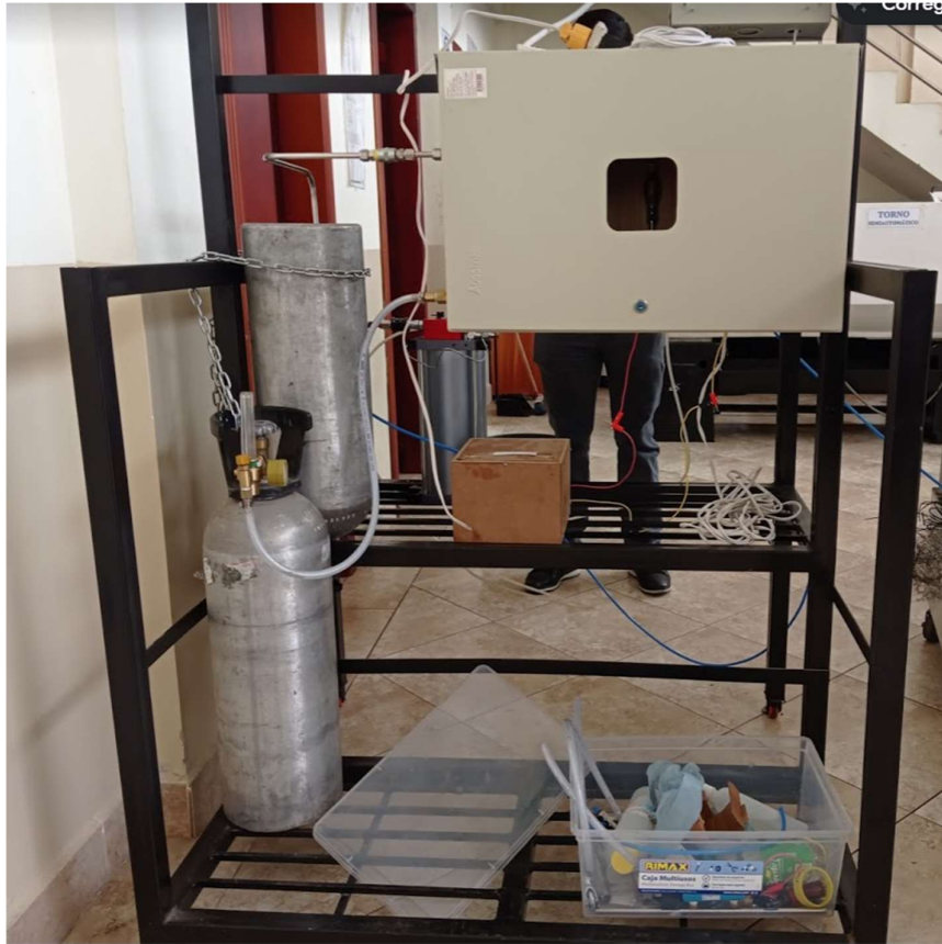
Anexo 5 Sistema de lubricación y enfriamiento híbrido compuesto de fluido criogénico de CO 2 y nano fluido pulverizado MQL
