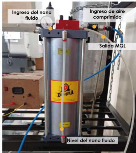
Fig. 21 Configuración del Sistema de lubricación MQL
