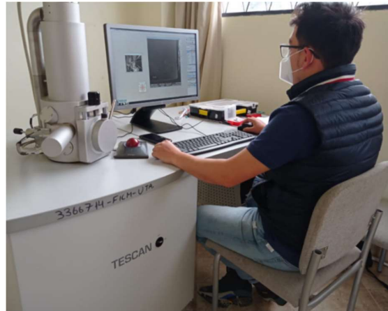
Fig. 15 Microscopía de barrido para la visualización del desgaste en las herramientas de corte
