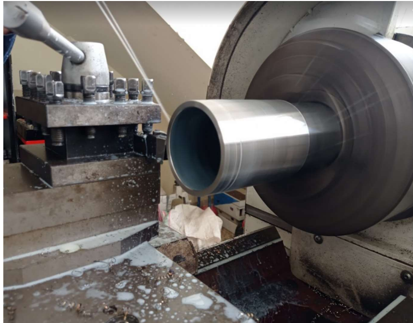
Anexo 1 Proceso de mecanizado con fluido de corte: taladrina
