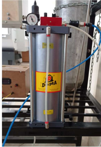
Fig. 9 Sistema MQL (Mínima cantidad de lubricante)
