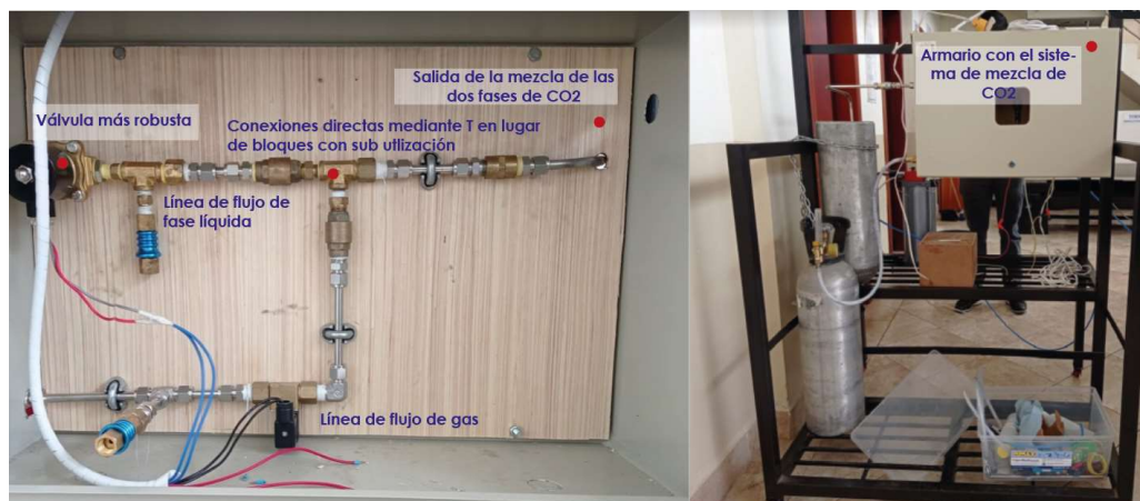
Fig. 24 Cambios en el circuito de mezcla y ubicación en el armario
