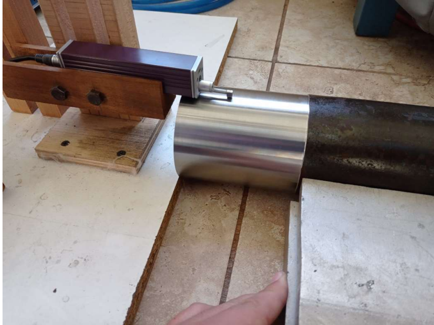
Anexo 3 Medición de la Rugosidad Ra y Rz con el rugosímetro Mitutoyo SJ10
