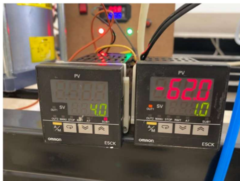
Fig. 19 Temperatura de trabajo del Sistema criogénico
