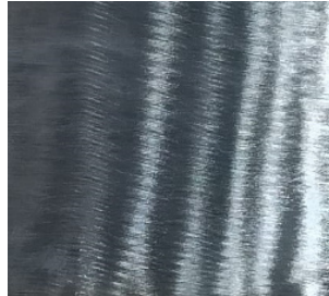
Probeta 003 Réplica 01, Inspección final. No hay presencia de discontinuidades. Aceptado. Nivel de calidad 1.
