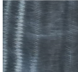
Probeta 004 Réplica 01, Inspección final. No hay presencia de discontinuidades. Aceptado. Nivel de calidad 1.
