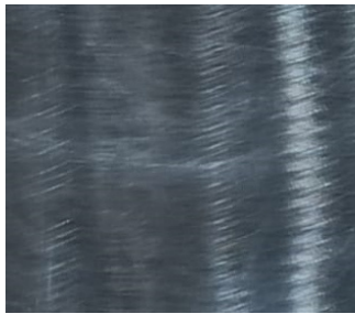
Probeta 003 Réplica 03, Inspección final. No hay presencia de discontinuidades. Aceptado. Nivel de calidad 1.
