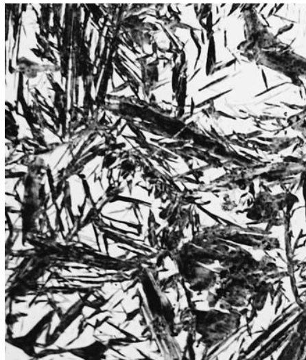
Figura 1-1: Micrografía de la estructura martensita. La forma de aguja los granos son la fase de martensita, y las regiones blancas son austenitas que no pudieron transformarse durante el enfriamiento rápido.[19]
