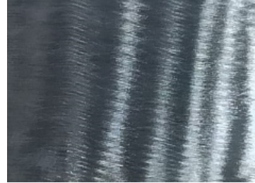
Probeta 003 Réplica 02, Inspección final. No hay presencia de discontinuidades. Aceptado. Nivel de calidad 1.
