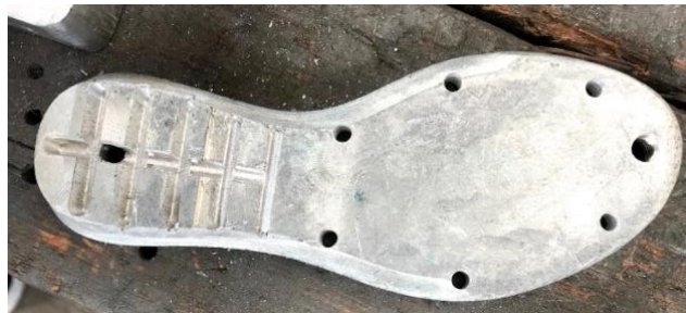
Figura 21. Agujeros para desgasificadores. [Autor]
