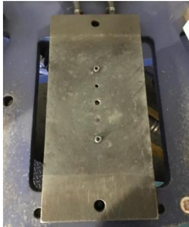
Figura 17. Placa refrigerada de la máquina inyectora. [Autor]
