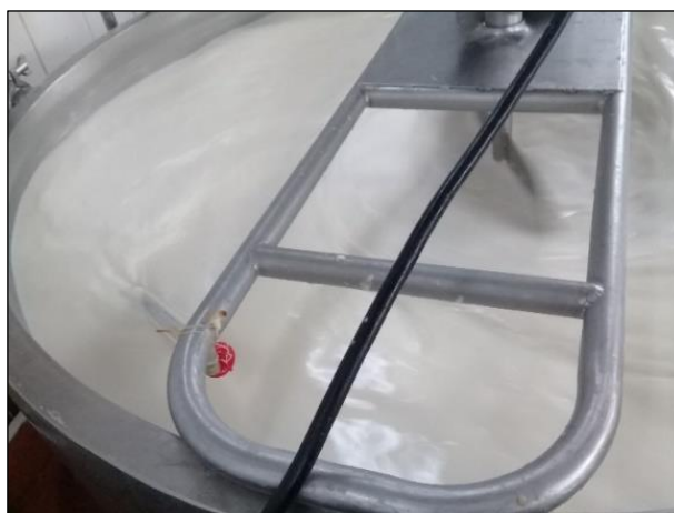
Figura 19: Termómetro colocado para la inspección de temperatura
