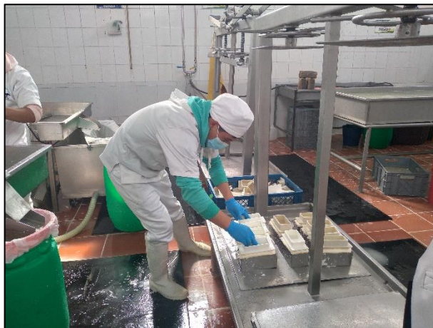
Figura 35: Colocar los tacos encima de los moldes
