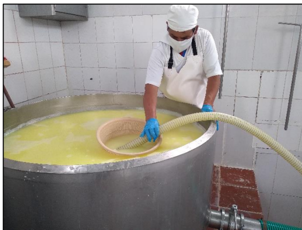
Figura 27: Proceso de desuerado o retiro del suero
