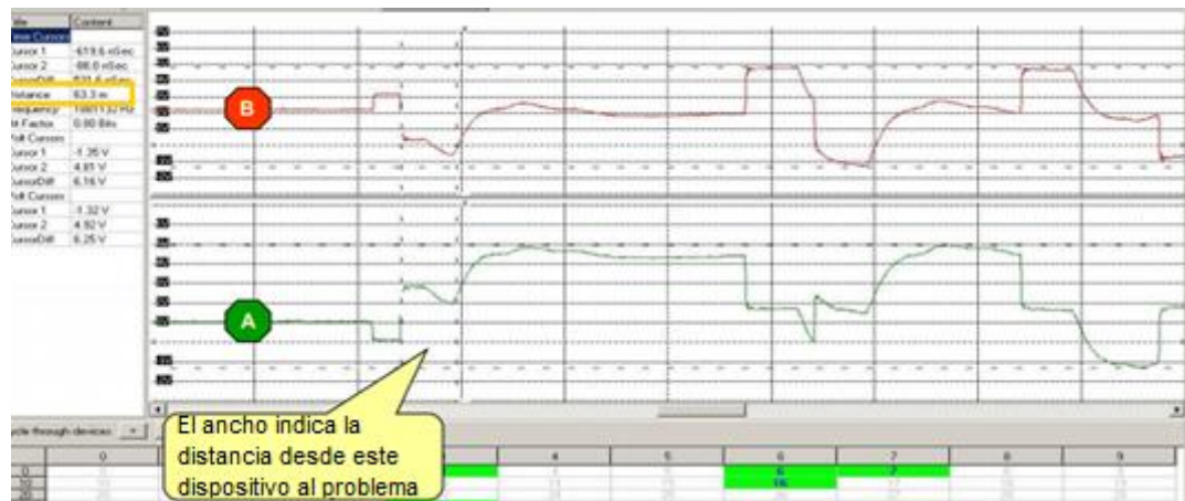
Fig. 4. 30. Corto circuito entre B y blindaje. [26]
