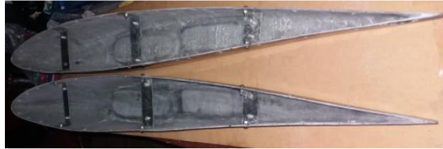
Figura 35.- Instalación de topes en las piezas previo al ensayo de flexión de 3 puntos.
