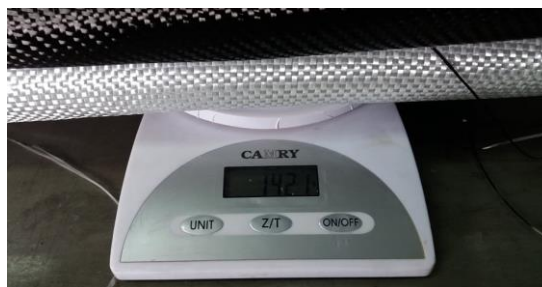
Figura 34. - Peso de los 2 pedazos de fibra de carbono y 6 pedazos de fibra de vidrio.
