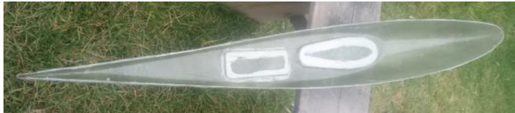
Figura 31. – Primera pieza obtenida (molde hembra).
