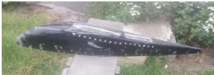
Figura 29.- Pieza original recubierta con cinta adhesiva (molde macho).
