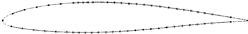
Figura 42.- Perfil alar del Super Tucano obtenido a partir del modelo CAD.
