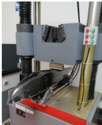
Figura 36.- Ensayo de flexión de 3 puntos del componente Wing Tip – Fairing Assy
