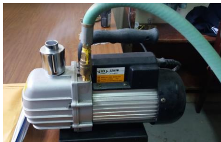
Figura 23.- Bomba de vacío.
