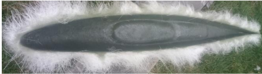
Figura 30.- Pieza con dos capas de fibra de vidrio y resina.
