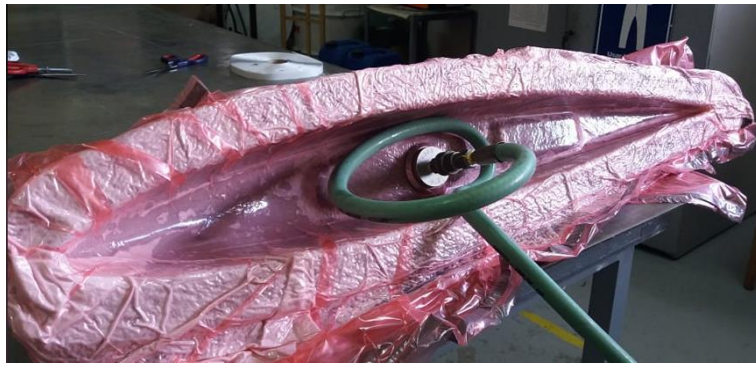
Figura 24.- Moldeado por proceso de bolsa de vacío.
