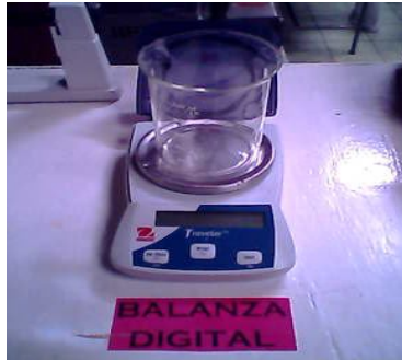
Descripción: Balanza digital Traveler OHAUS (500g)
