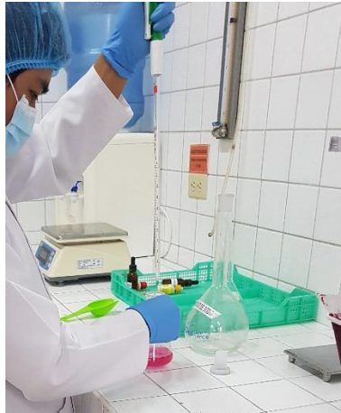
Figura 5. Determinación de acidez a través de titulación
