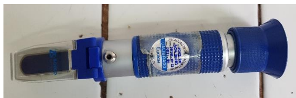
Figura 6. Refractómetro manual BOECO
