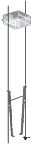
Figura 13. Tanque de Carga Constante
