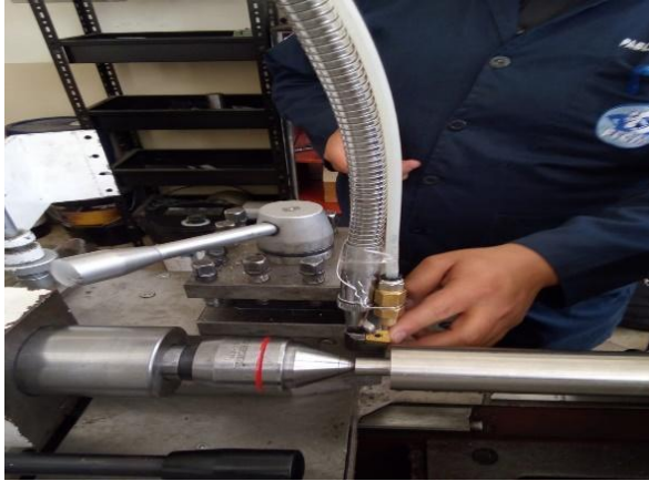
Figura 3. 36.-Prueba líquido iónico [Autores]
