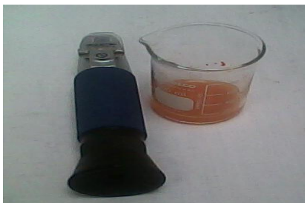
Fotografía F-6. Determinación de Sólidos solubles (°Brix) en jugo.
