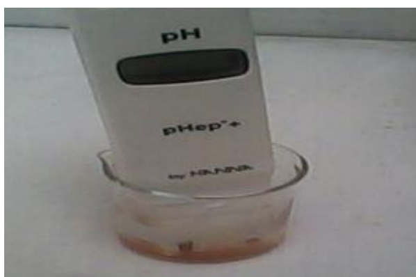
Fotografía F-5. Determinación de pH en jugo.
