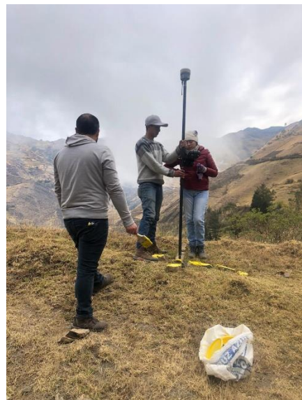
Anexo B - 8. Instalación y topa del punto de referencia con la estación móvil
