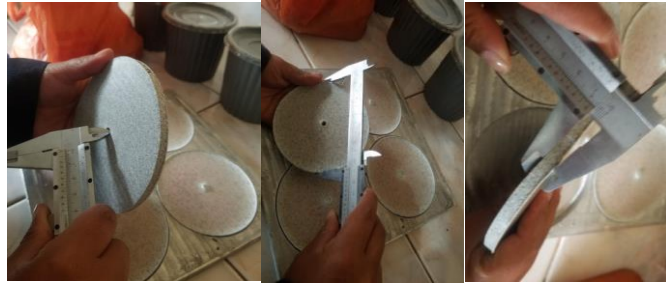
Fig 2. 12. Verificación de dimensiones del composite.
