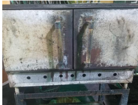
Fig 2. 10. Vulcanización de probetas en el horno.
