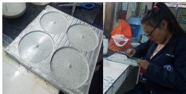
Fig 2. 11. Extracción de probetas del molde.
