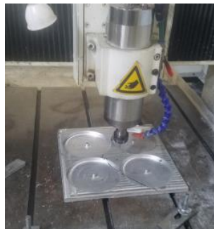
Fig 2. 2. Proceso de mecanizado de molde
