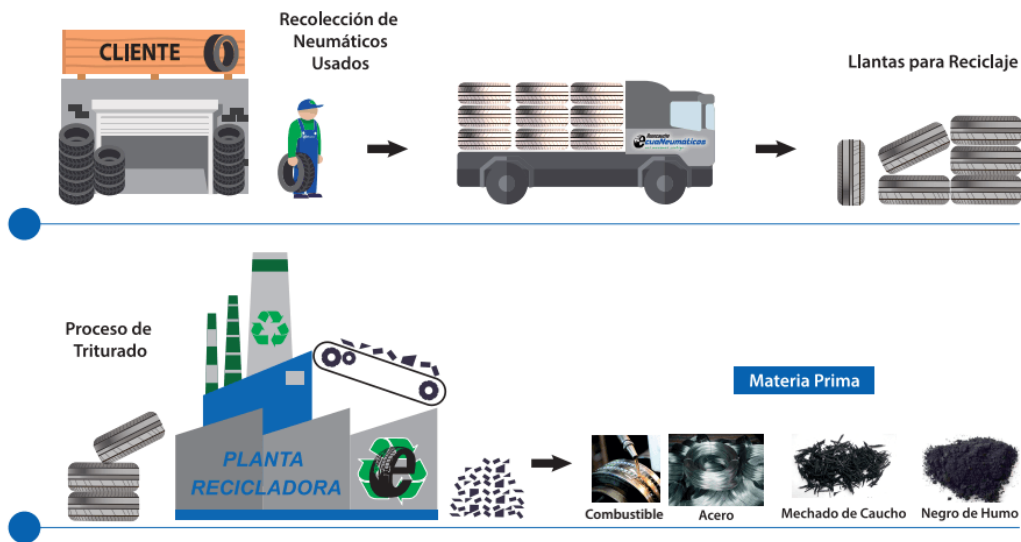
Fig 1.24. Secuencia de reciclaje de neumáticos [36].
