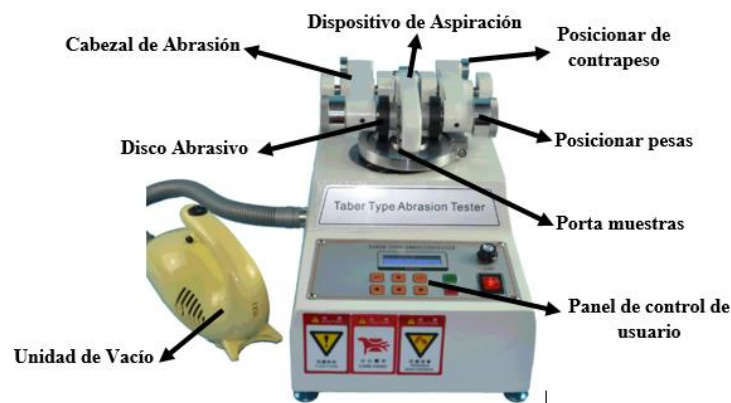
Fig 1.32. Abrasímetro para pruebas rápidas de desgaste.
