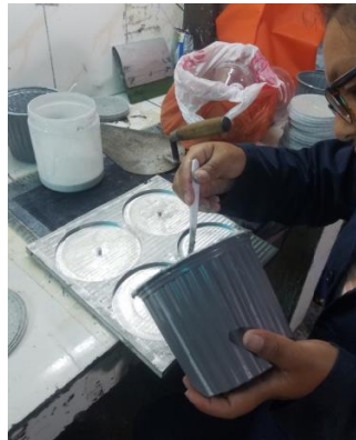
Fig 2. 8. Agregado de mezcla sobre molde de Aluminio.
