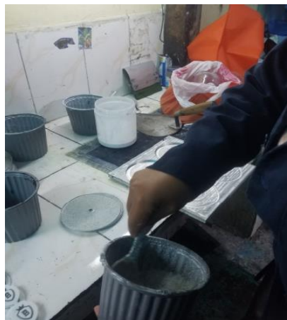
Fig 2. 7. Mezcla de Látex y PGCR.
