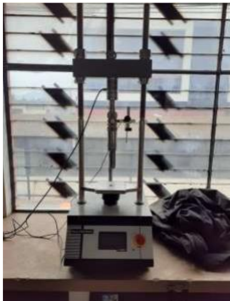
Ensayo de CBR – Máquina Multispeed 34-V1172
