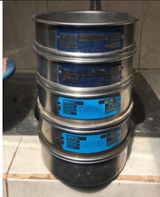
Foto 10.- Determinación de granulometría
