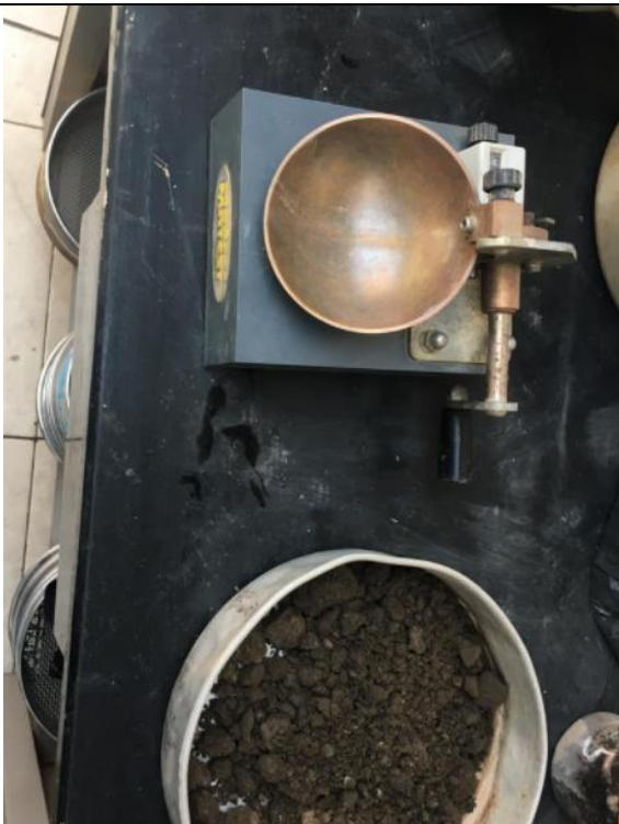
Foto 11.- Determinación de plasticidad
