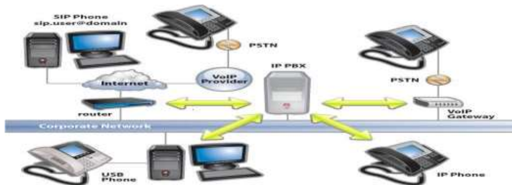
Figura 9 Centralita IP/un sistema telefónico VOIP [23]
