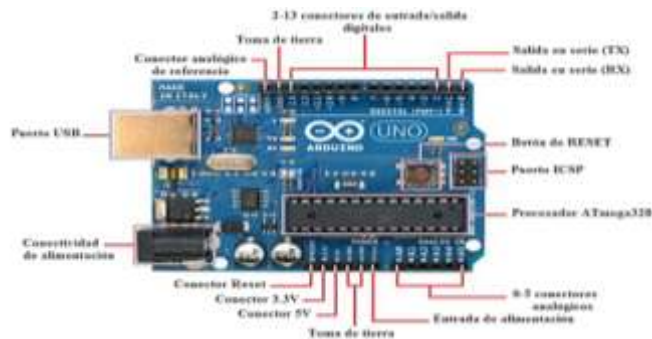
Figura 16 Descripción de las entradas/salidas de la tarjeta Arduino Uno [36]
