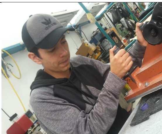
Extracción de probeta para ensayo de Compresión
