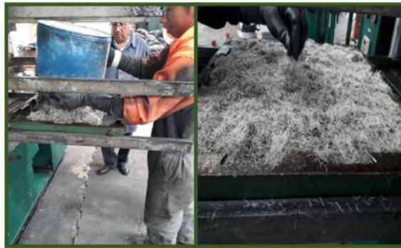
Figura 27: Disposición del material premezclado en el molde
