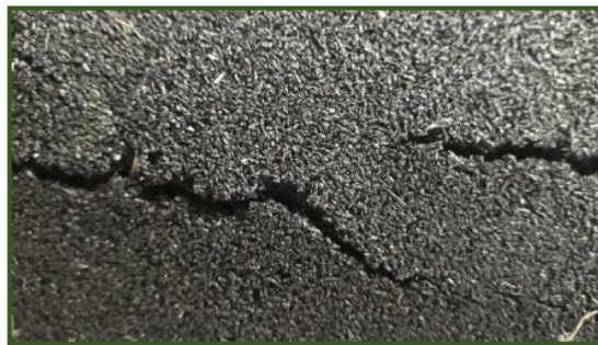
Figura 66: Configuración: 5% resina - 95% gránulo
