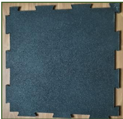
Figura 67: Configuración: 10% resina - 90% gránulo
