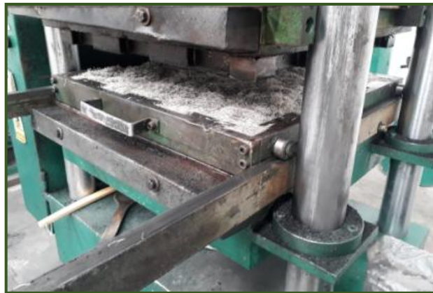
Figura 28: Molde con el material compuesto listo para la compactación
