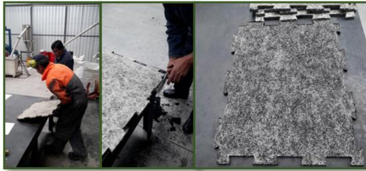
Figura 31: Pieza retirada del molde, corte de rebabas, resultado final
