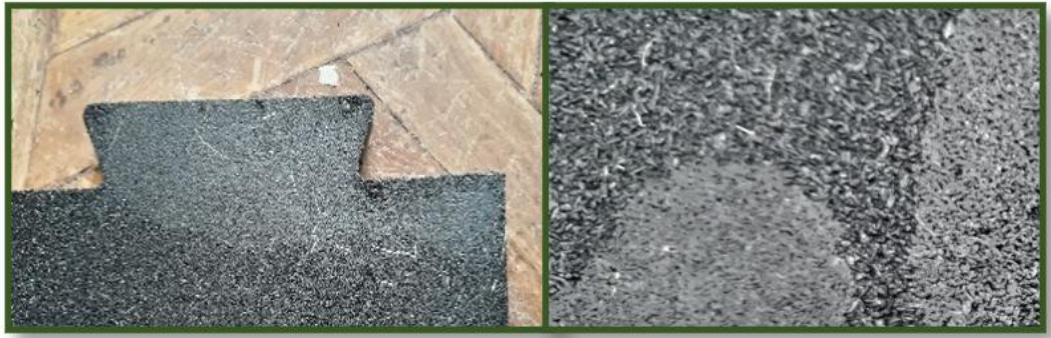
Figura 68: Configuración: 15% resina - 85% gránulo
