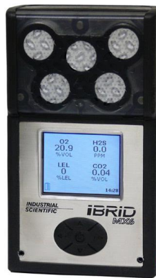
Figura 3. Medidor de gas MX6 iBRID (H 2 S, O 2 , CO 2 , LEL)
