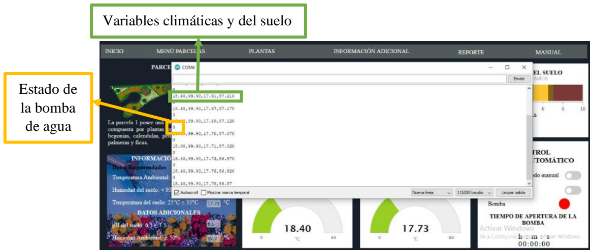
Figura N° 63. Prueba de envío de datos de los sensores y estado de la bomba de agua en el módulo ESP32.
