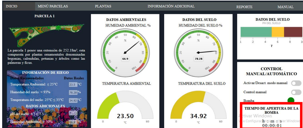
Figura N° 39. Página de control y visualización, sección de tiempo de apertura de la bomba.
