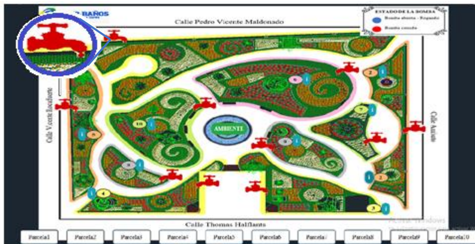
Figura N° 71. Indicador apagado en la página principal de la desactivación del sistema de riego.
