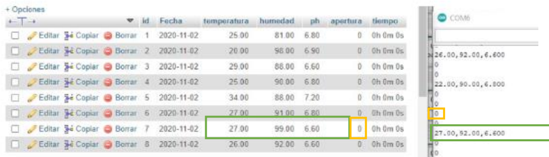
Figura N° 67. Envío de datos del suelo y recepción del estado de la bomba de agua por la ESP8266.
