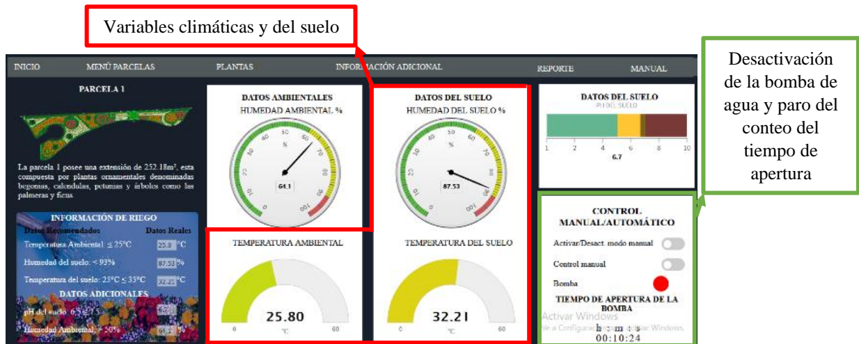
Figura N° 70. Desactivación del funcionamiento del modo automático del sistema de riego al dejarse de cumplir las condiciones.
