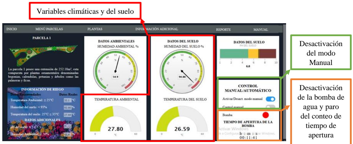
Figura N° 73. Desactivación del funcionamiento del mono manual del sistema de riego.
