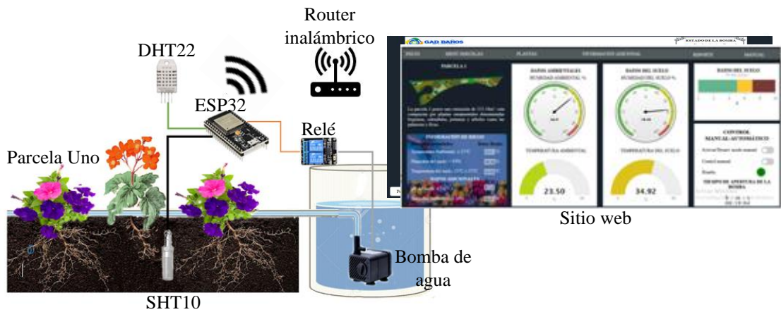
Figura N° 58. Diseño gráfico del sistema de riego implementado en la Parcela uno del prototipo.
