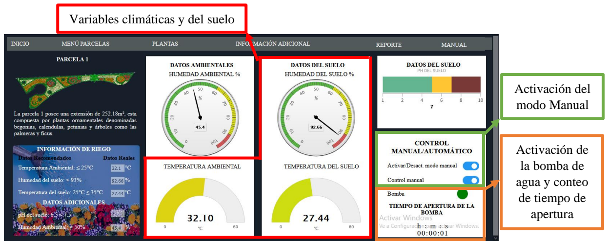
Figura N° 72. Funcionamiento del mono manual del sistema de riego.
