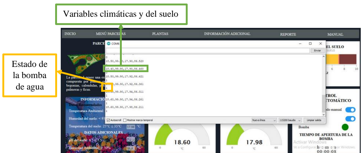
Figura N° 64. Prueba de envío de datos de los sensores y estado de la bomba de agua en la tarjeta ESP32.
