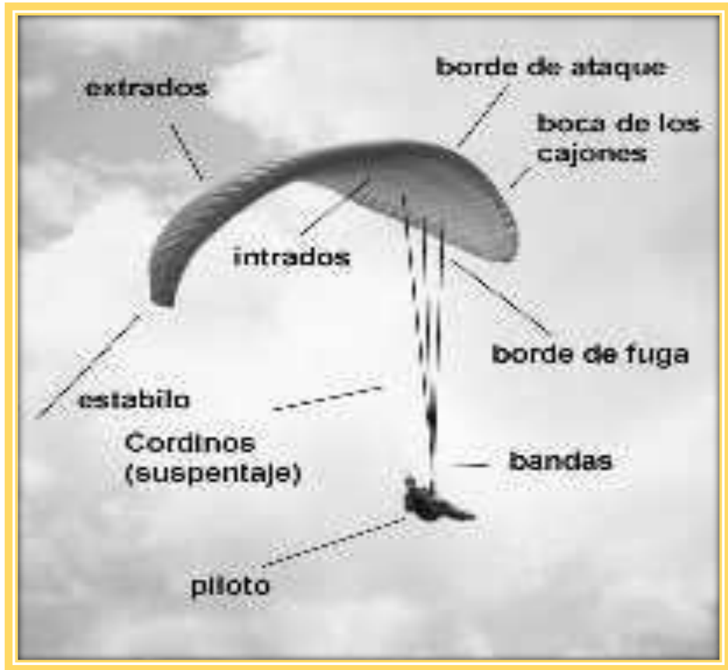
GRAFICO 1.- PARTES DEL PARAPENTE
