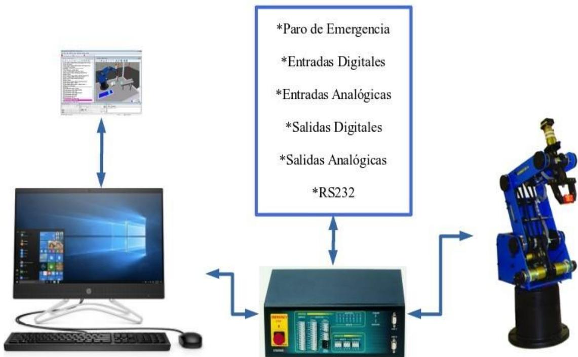
**Figura 3.1:** Diagrama de conexión del Scorbot ER\_4U.
