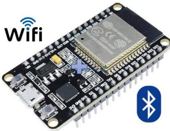
**Figura 1.10:** Tarjeta ESP32 combinada con capacidad inalámbrica Wifi y Bluetooth [34].
