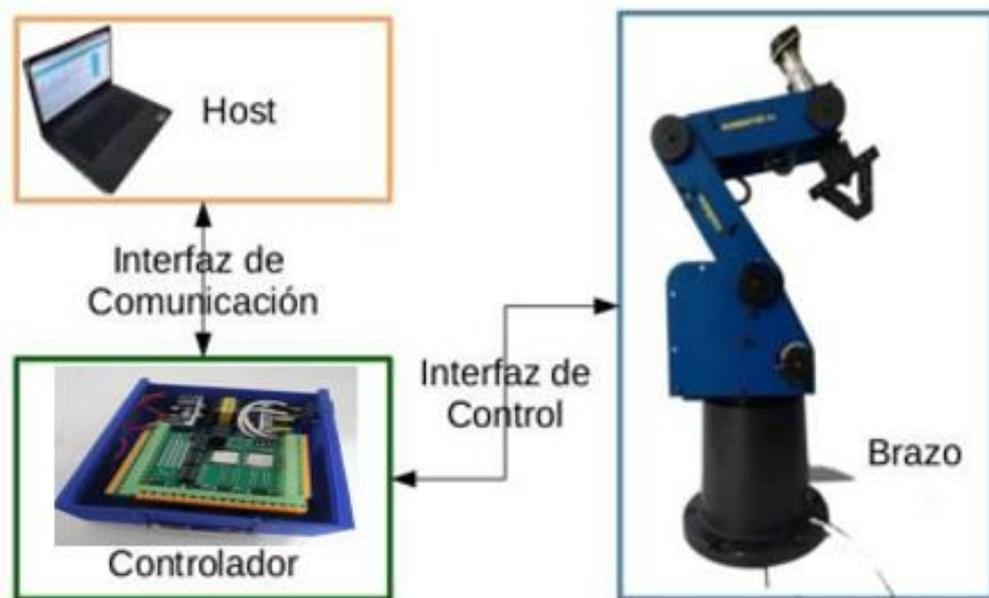
**Figura 3.6:** Diagrama de bloques del sistema general.
