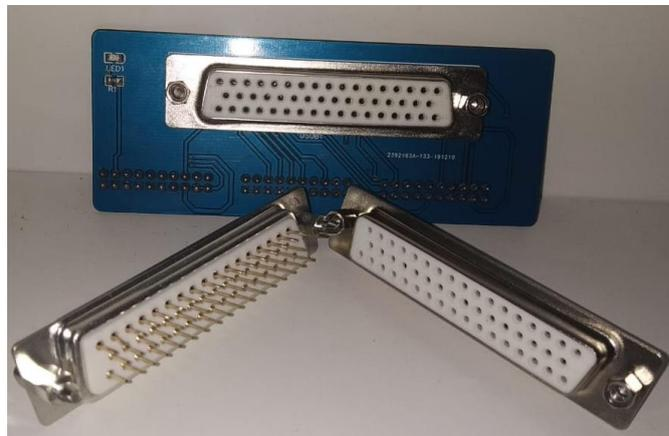
**Figura 3.7:** Interfaz electrónica del Scorbot ER\_4U, terminal DD50.
