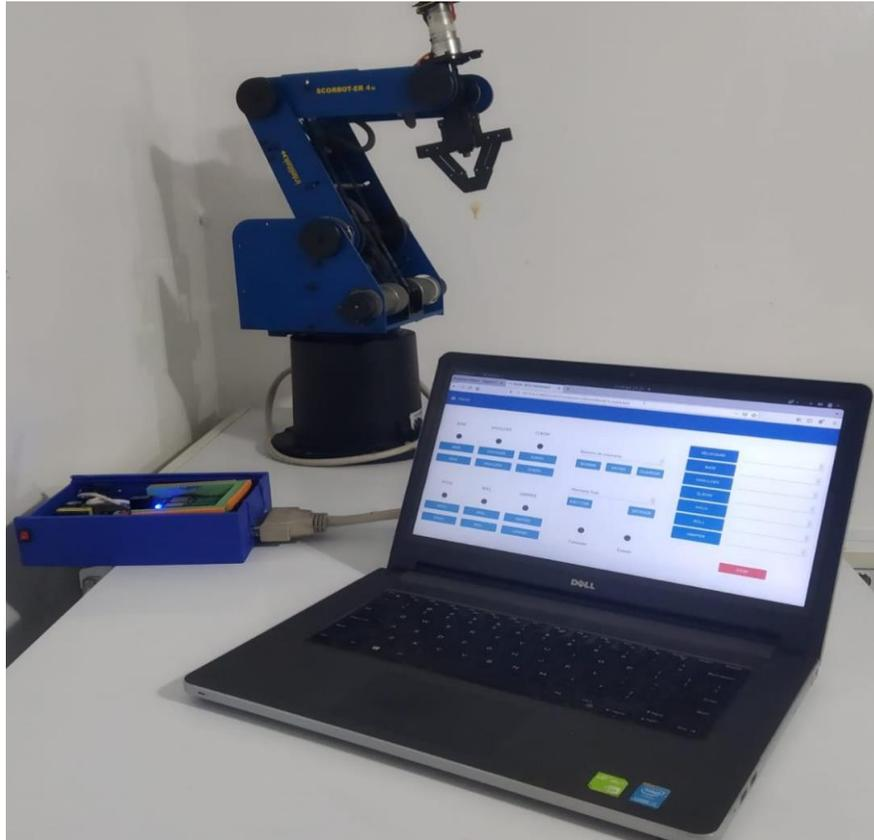
**Figura 3.29:** Manipulación del Scrobot mediante MQTT.
