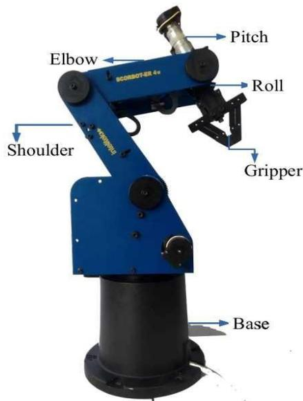
**Figura 3.2** : Ejes de rotación del Scorbot ER\_4U [27].
