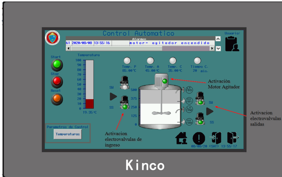
Figura 126. Pantalla de Control Automático prueba de funcionamiento
