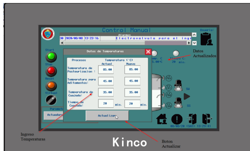
Figura 123. Pantalla de Control Manual actualización de Temperaturas de proceso
