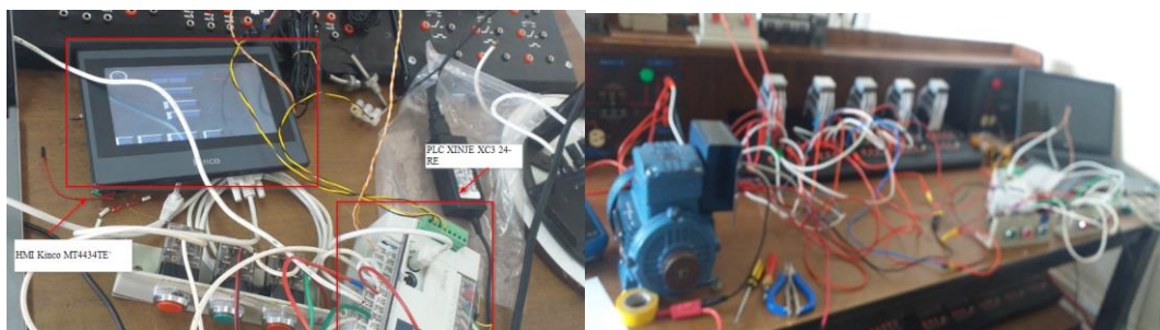
Figura 117. Pruebas de Funcionamiento en laboratorio del sistema de control Elaborado por: El investigador
