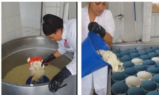
Figura 44. Método de moldeo utilizado para la elaboración de quesos
