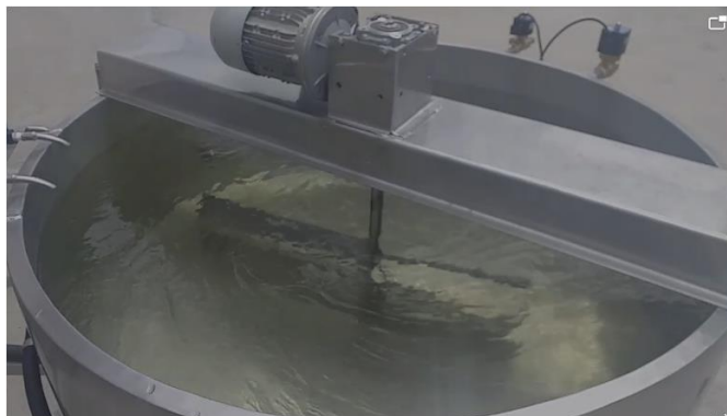
Figura 127. Pruebas de Funcionamiento del agitador de paletas
