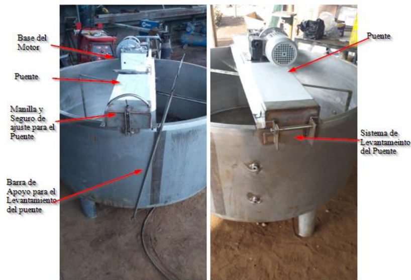
Figura 109. Adaptación del Puente para soporte del Motor Agitador Elaborado por: El investigador
