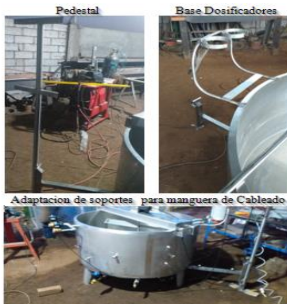
Figura 112. Adaptación Pedestal, Soportes Cables y Base Dosificadores Elaborado por: El investigador
